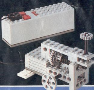
Мини-мотор может быть скомбинирован с более мощными моторами и, тем не менее, Вы можете «спрятать» их в своих моделях. Питание через кабель и 9-вольтовый пульт управления. Во всех наборах имеются инструкции по установке мотора.
